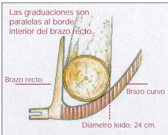
La más extendida y usada es la de brazo móvil, con un brazo graduado, bien en centímetros (hasta milímetros), bien en clases diamétricas, llamándose entonces forcípula compensada. De estas las más utilizadas son las que tienen una amplitud de 5 cm, lo que significa por ejemplo que un árbol de diámetro 35 cm tiene en realidad un diámetro comprendido entre 32,5 y 37,5 cm.
