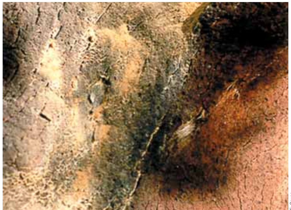
FOTO 1. SERRÍN SALIENDO DEL ORIFICIO DE ENTRADA DEL INSECTO
