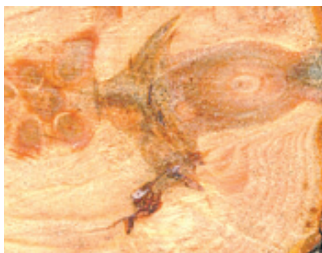
FOTO 5: REDUCCIÓN DE LA CALIDAD DE LA MADERA POR LA IMPREGNACIÓN DE RESINA EN EL PUNTO DE ATAQUE
