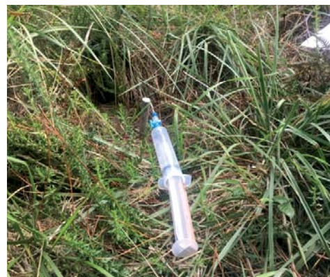
DETALLE DE LA JERINGA DE VACÍO CON LA QUE SE RECOGEN LAS MUESTRAS DE AGUA INTERSTICIAL
