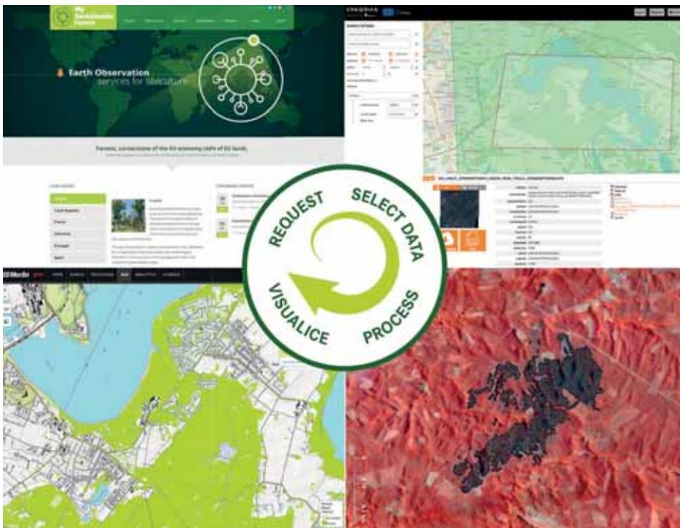
PLATAFORMA DE SERVICIO: (SI) FORMULARIO DE SOLICITUD VÍA WEB. (SD) ÁREA DE INTERÉS Y MANEJO DE DATOS VÍA DIAS. (ID) MÁSCARA DE ÁREA QUEMADA TRAS APLICACIÓN DEL ALGORITMO O PROCESO API. (II) PRODUCTO EN VISOR GIS Y SERVICIO DE DESCARGA
